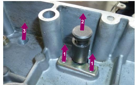
4. Соблюдая соосность осей и отверстий соединительной планки, а также учитывая взаимное расположение тележки и тали (двигатели должны находятся с одной стороны), установите соединительную планку на таль. Произведите сборку в обратном порядке.
